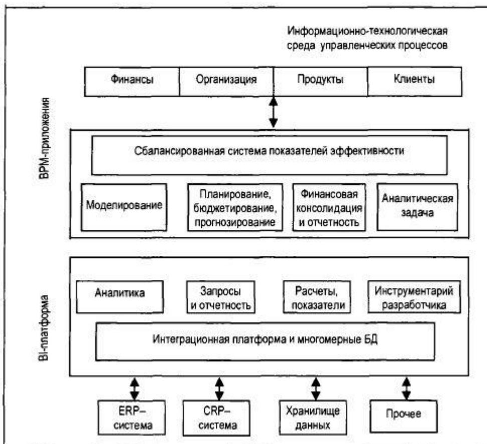
*Рис. 2.5. Типовая архитектура информационно-технологической среды управленческих процессов*
