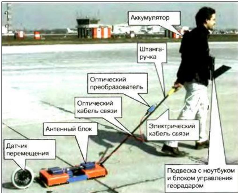
Рис.3.9. Георадар «ОКО-М» с антенным блоком [12]
