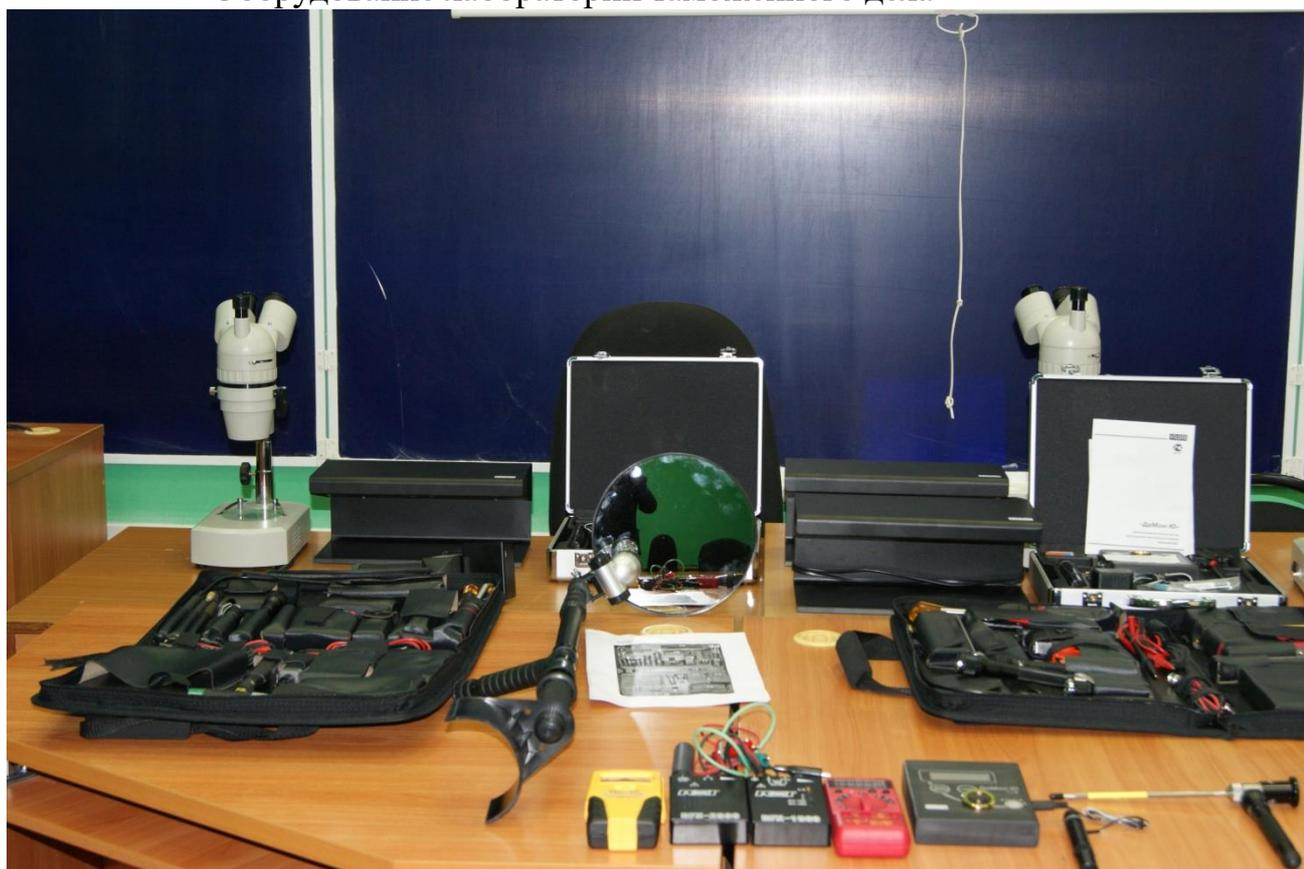
Рис. 10 Оборудование лаборатории таможенного дела (на фото представлены: ультрамаг-КЗ, стереомикроскоп ХТВ-В1 с цифровой камерой «Крим Б5», досмотровые зеркала "ШМЕЛЬ-3N", жесткий эндоскоп с фонарем (бороскоп), электрохимический детектор драгоценных металлов и сплавов и др.)
