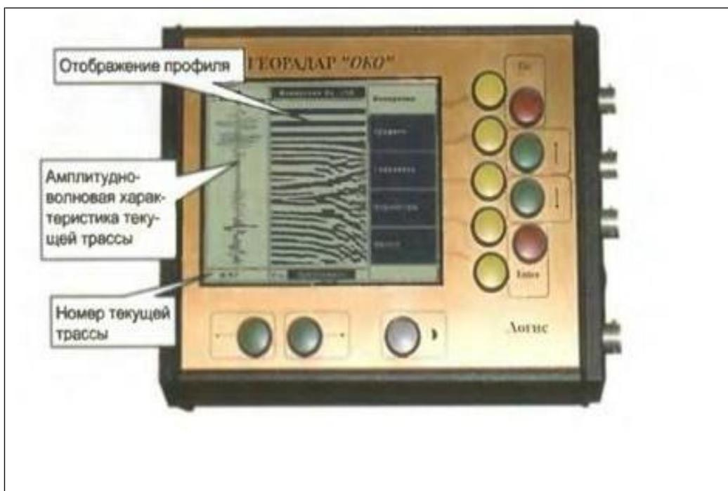
Рис.3.10. Блок обработки результатов зондирования [10]
