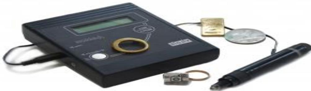
Рис. 7. Электрохимический детектор драгоценных металлов и сплавов
