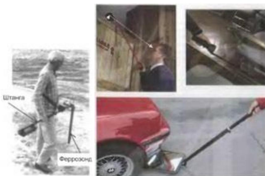
Рис.3.4. Металлодетектор феррозондовый.[10]
