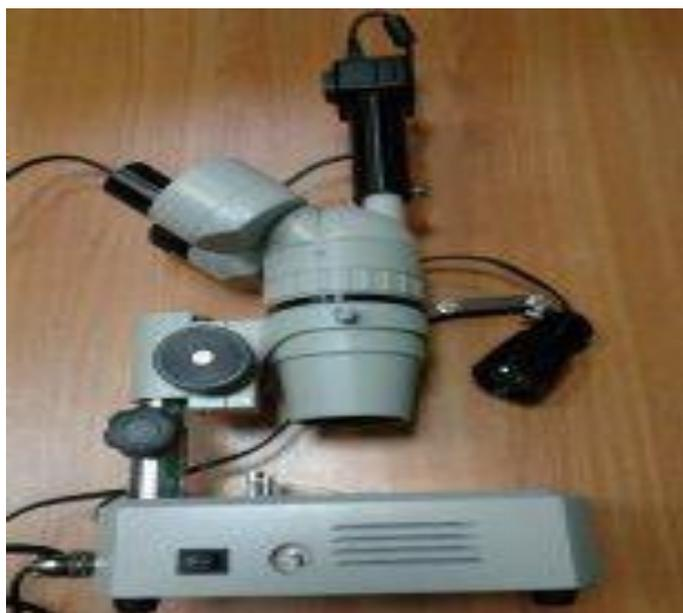
Рис. 8. Стереомикроскоп ХТВ-В1 с цифровой камерой «Крим Б5»
